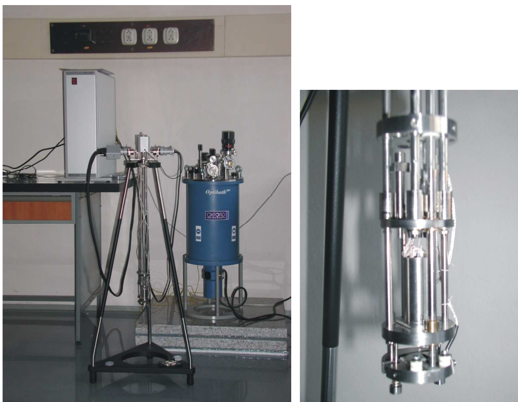
Obr.6.13 Kryogénny Rastrovací silový mikroskop s antivibračným kryostatom Oxford Instruments Optistat SXM (vľavo) a detail hlavice Rastrovacieho silového mikroskopu (vpravo)
