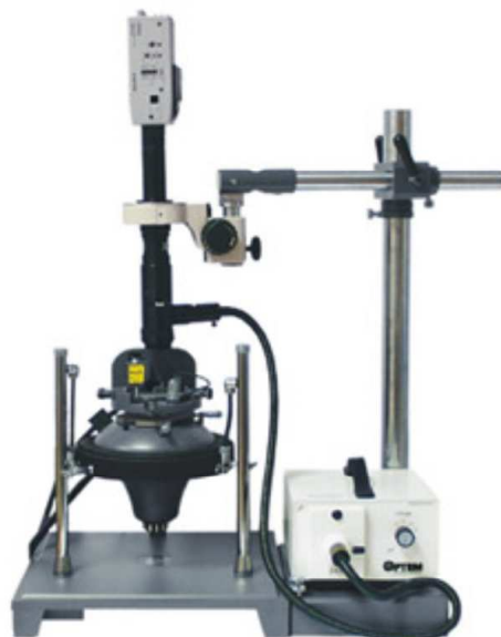
Obr.6.12 Hlavica Rastrovacieho silového mikroskopu NT MDT typ SOLVER P47 s optickým mikroskopom a CCD kamerou pre nastavenie laserového lúča.
