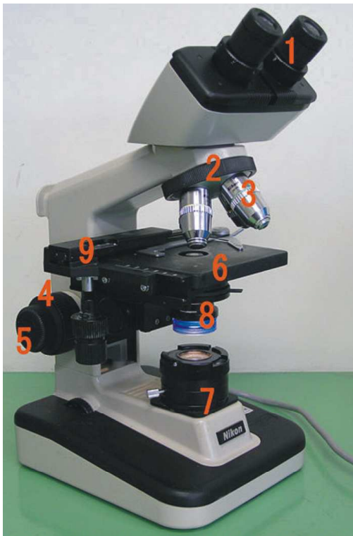
Obr. 1.2 Základné časti a príslušenstvo mikroskopu pre pozorovanie v prechádzajúcom svetle: 1 – binokulárna hlavica, 2 – revolverový nosič objektívov, 3 – mikroskopický objektív, 4 – skrutka hrubého zaostrovania, 5 – skrutka jemného zaostrovania, 6 – mikroskopický xy stolík, 7 – Koehlerovský zdroj svetla, 8 – kondenzor s apertúrnou clonou, 9 – skrutky polohovacieho stolíka
